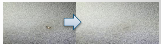
冷却・加熱キャストイングロール (鏡面マット) 傷修理
